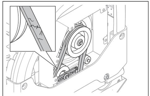
4. Kontrollieren Sie die Riemenspannung des Keilriemens.
