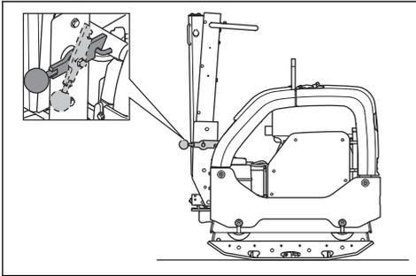
2. Befestigen Sie die Hebevorrichtung an der Hebeöse.
