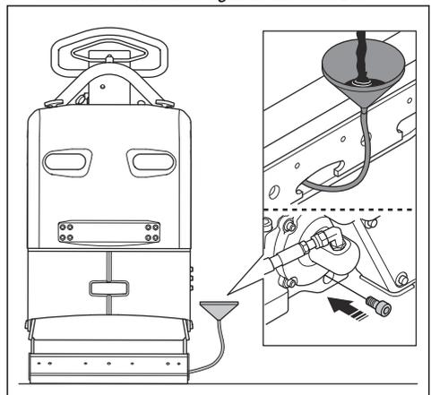
5. Installieren Sie die Ölablassschraube.
