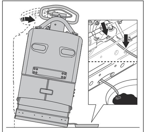
**Hinweis:** Sie können auch eine manuelle Ölablasspumpe verwenden, um das Öl im Exzenterelement abzulassen.
