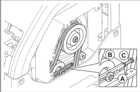
b) Lösen Sie die Sicherungsmutter (B).
