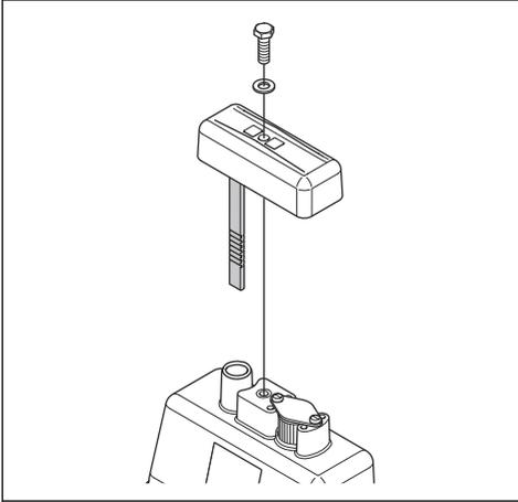
2. Prüfen Sie den Hydraulikölstand am Messstab.
