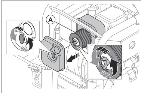
2. Drehen Sie den Verriegelungsknopf am Luftfilter gegen den Uhrzeigersinn und entfernen Sie den Luftfilter (A) aus dem Luftfiltergehäuse.
