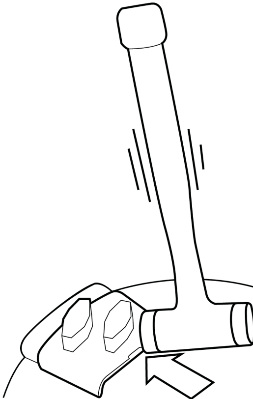
Figura 4-4. Fijación de la herramienta pulidora
