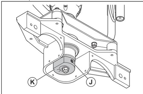
4. Поверните эксцентриковый элемент (K), чтобы отрегулировать вес. В таблице ниже показано, насколько необходимо поворачивать эксцентриковый элемент в зависимости от типа перекладин и подвижности бетона. На эксцентриковом элементе имеются 4 метки: 62%, 75%, 87% и 100%.
