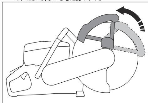
3. 押し込んでもすぐに元に戻らない場合や損傷している場合は、SmartGuard を清掃するか、交換します。
