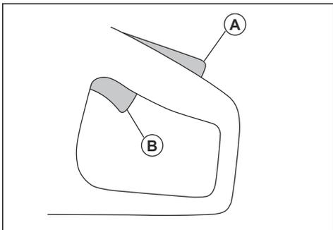
ハンドルから手を放すと、パワートリガーとパワートリガーロックは元の位置に戻ります。この機能により、パワートリガーがロックされ、本製品が停止します。水バルブは閉位置に戻ります。
