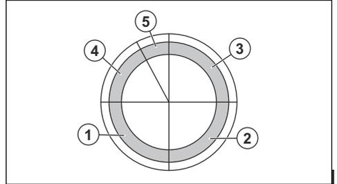
• اقطع هذه الأجزاء في 5 خطوات باستخدام اتجاهات القطع الموضحة بالأسهم في كل خطوة.
