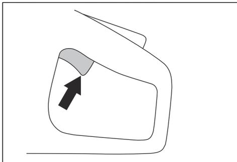
5. パワートリガーを放し、カッティングブレードが 10 秒未満で停止して静止状態が保たれることを確認します。
