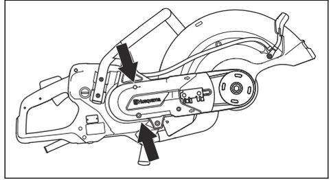
6. 拆下后皮带保护罩。
