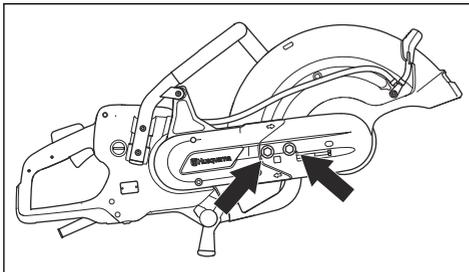
2. 转动调节螺丝，直到调节螺母与驱动皮带保护罩上的标记相对。
