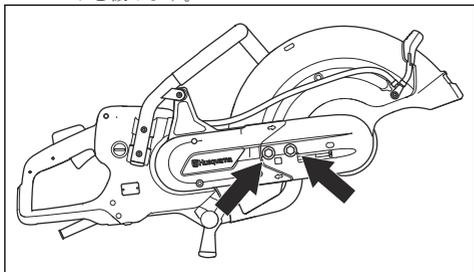
2. 2本のボルトと調整ネジを緩めて、ベルトの張力を緩めます。
