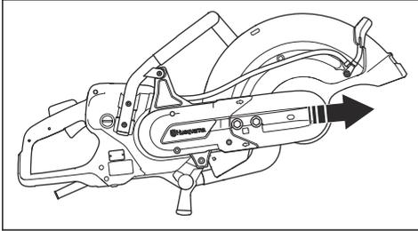
4. 水ホースニップル、水ホース、ハンドルをブレードガードから外します。留め具を外します。
