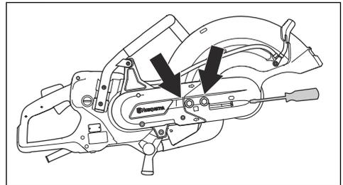
3. 拆下 2 颗螺丝，并拆下皮带保护罩。
