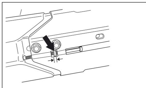
1 時間作業した後に新しいドライブベルトを締めてください。
