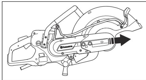
3. コンビレンチを使用して、Cuttingヘッドを本製品に固定している2本のボルトを締めます。
