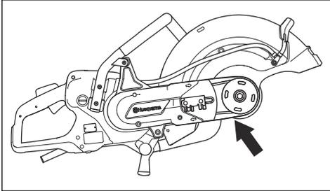
6. ベアリングハウジングを反対方向に回し、留め具を取り付けます。
