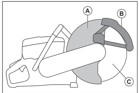
SmartGuard 采用弹簧张紧，必须始终可自由移动并通过弹簧力缩回到初始位置。
