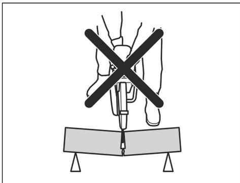
ブレードのキックバックゾーンが挟まったり、引っかかったりすると、反作用力により、作業者に向かってパワーカッターが回転しながら飛ばされて、人命にかかわるような事故が発生することがあります。作業対象物が動く可能性があるので、注意してください。作業対象物がしっかりと保持されておらず、切断時に動くと、ブレードが挟まり、キックバックの原因になる可能性があります。
