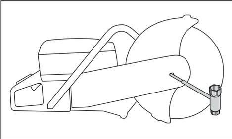
5. 将切割锯片螺栓上紧至 25 牛米/18.5 英尺磅。
