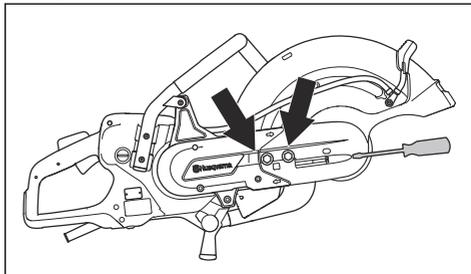
3. ボルトを外し、ベルトガードを解放します。
