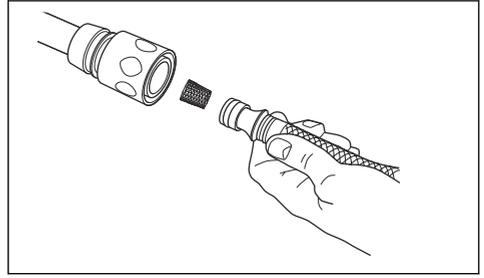
**注意：** 产品的软管接头配有过滤器。
