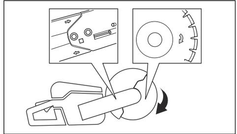
2. 找到锯片防护罩上显示切割锯片旋转方向的箭头。
