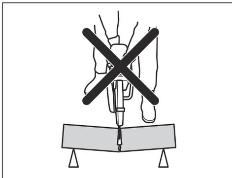
如果锯片在反弹区被夹住或停转，反作用力会将切割锯向上向后抛起，飞向使用者，造成严重甚至致命性伤害。要警惕工件可能的移动。如果工件未妥善支撑并在切割时发生移位，可能会夹住锯片，导致反弹。
