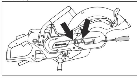
2. 調整ナットがドライブベルトカバーのマークの反対側にくるまで、調整ネジを回します。
