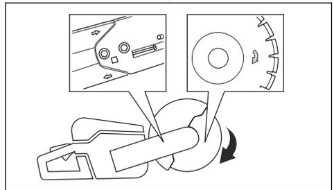
2. カッティングブレードの回転方向を示すブレードガードの矢印を見つめます。
