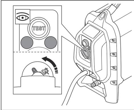
3. RCD が作動して本製品が電源から切断されることを確認してください。
