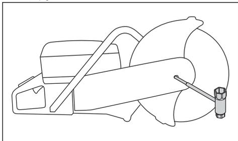
5. Cutting ブレードボルトを 25 Nm/18.5 ft-lb で締め込みます。
