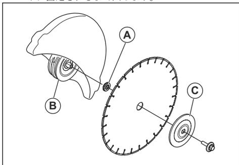
4. 工具をフロントベルトガードの穴へ入れ、シャフトがロックされるまで Cutting ブレードを回転させます。
