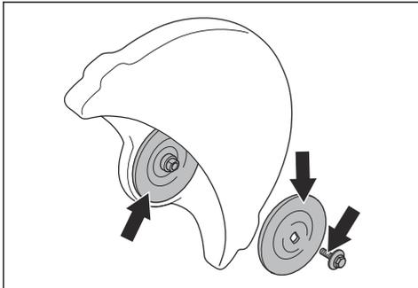
2. カッティングブレードとフランジウォッシャーの接触面が損傷していないことを確認します。破損した部品は交換してください。
