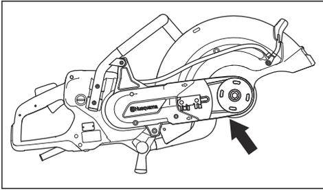
6. 向相反方向转动轴承座，装配停止装置。
