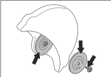
2. 确保切割锯片和凸缘垫片上的接触区域未损坏。更换损坏的部件。
