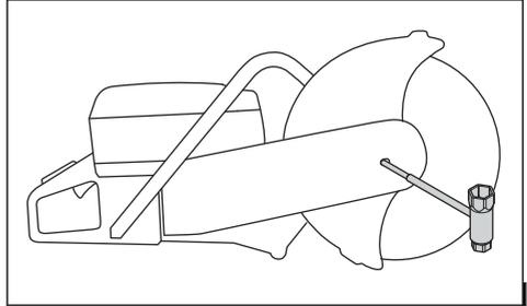
5. اربط مسمار شفرة القطع بقوة 25 نانومتر/18.5 قدم-رطل.
