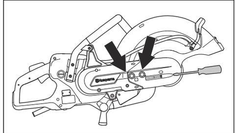
3. 拆下螺丝，并松开皮带保护罩。
