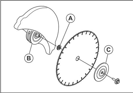
4. 将工具放入前皮带保护罩的孔内，并转动切割锯片，直至轴被锁定。
