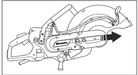
4. 从锯片防护罩上断开水管接头、水管和手柄。拆下停止装置。
