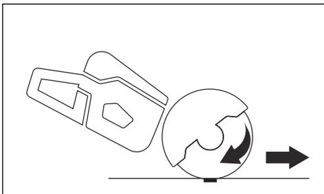
カッティング装置を回転させたまま、本製品を移動しないでください。ジャイロ力により、意図した動きが阻害される場合があります。
