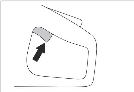
5. 松开开关扳机，确保切割锯片在 10 秒内停止并保持静止不动。
