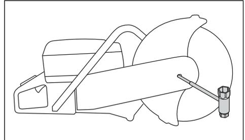
2. 拧松 2 颗螺丝，然后拧松调节螺丝，以释放皮带张力。
