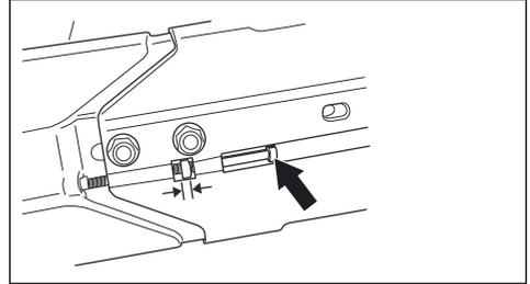
3. 使用组合扳手，拧紧将切割头固定至产品上的 2 颗螺栓。
