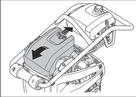
3. Entfernen Sie den Luftfilter vom Luftfiltergehäuse.
