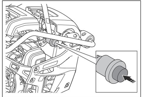
10. Klappen Sie den Luftfilterdeckel nach unten, und bringen Sie die Gummiverriegelung wieder in die verriegelte Position.
