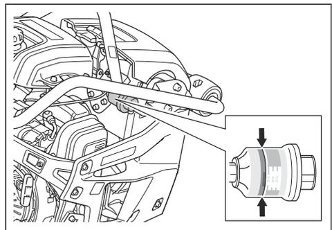
2. Heben Sie die Gummiverriegelung vorsichtig an, und ziehen Sie sie vom Luftfilterdeckel weg. Klappen Sie den Luftfilterdeckel nach vorn.
