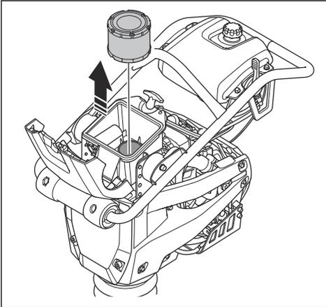
4. Reinigen Sie das Luftfiltergehäuse mit einer Bürste.
