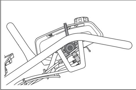
2. Wenn der Motor kalt ist, drücken Sie die Kraftstoffpumpe 5 Mal.
