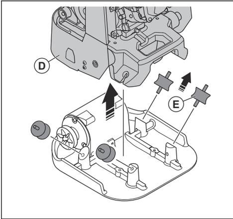
7. Retire los 4 amortiguadores de vibraciones (E).
