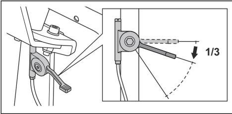
3. Coloque el estrangulador en la posición correcta.
